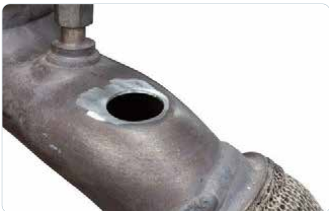
5. Bohrung entgraten. Bohrspäne sorgfältig entfernen.
