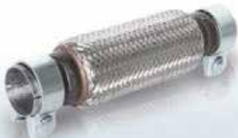
Flexrohr · HJS-Nr. 83 00 8440 Maße: Rohr-Ø-Innen: 43,0 mm; L-ges: 225 mm
