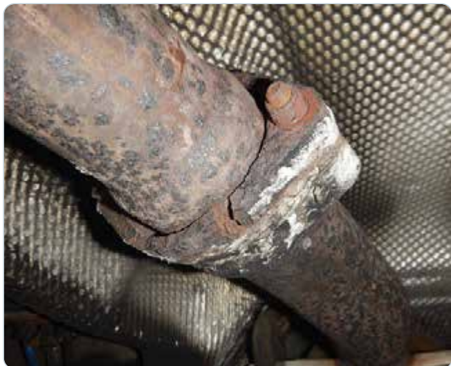
Abbildung zeigt Flanschverbindung am BMW 530i
