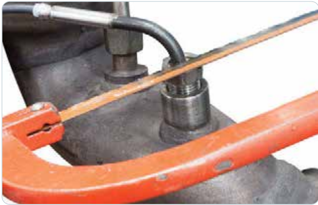
1. DPF® gemäß Herstellerangaben ausbauen. Defekten Temperatursensor (Anschluß / Sensorrohr) abtrennen.
