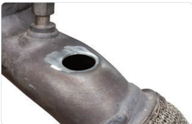
5. Bohrung entgraten. Bohrspäne sorgfältig entfernen.
