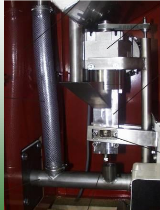
KSM-Multistoker med indbygget rapsoliepresser.
