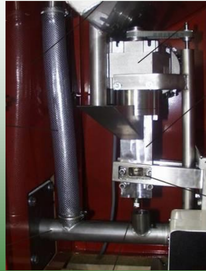
KSM-Multistoker med indbygget rapsoliepresser. Patenteret konstruktion
